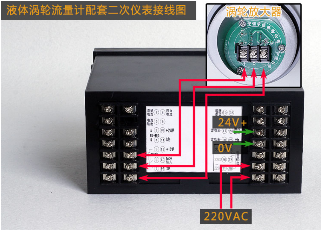
4~20mA 电流输出接线示意图：
